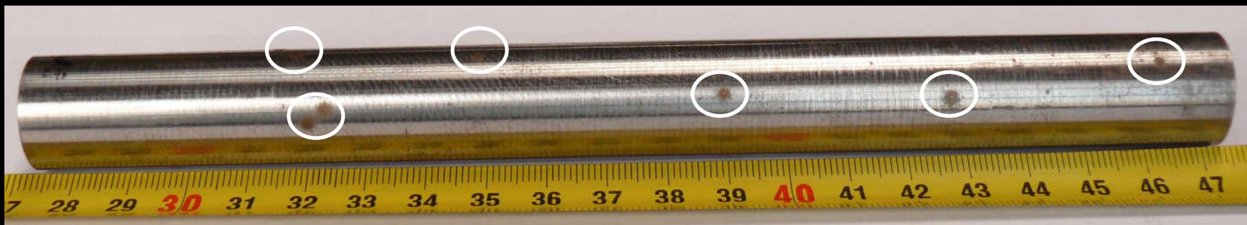
**Barra di acciaio dopo l'applicazione di 5 minuti di ultrasuoni a 19 Watt. Sono visibili 8 zone di danneggiamento da emissione di impulsi di neutroni.**
