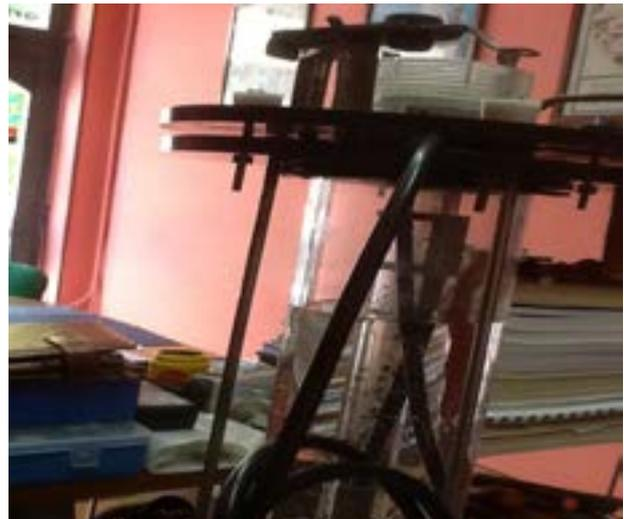
smaltimento termico dell'acqua contenuta nel circuito primario (cil.esterno) , verso un secondo circuito. Ciò è reso possibile attraverso l'utilizzo di una pompa di ricircolo per poi giungere a uno scambiatore secondario.
