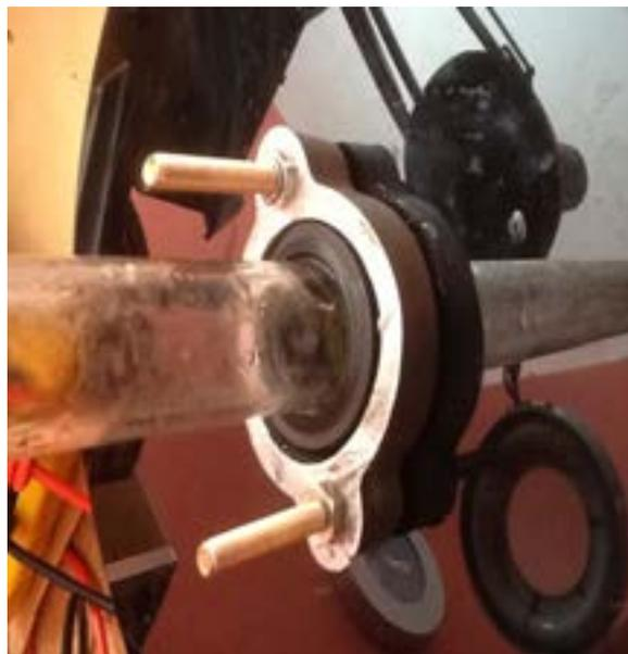
Un cilindro in Pirex (resistente ai sbalzi termici) , con base convessa, nella porzione inferiore presenta un foro localizzato al centro, dove si inserisce un cavo elettrico isolato, che permette la comunicazione con il connettore ( all'interno del cil.) e con l'alimentazione elettrica (all'esterno del cil.) Polo negativo.
